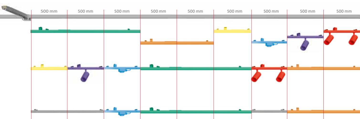
Anordnung im 500 mm Modulmaß von Tragprofilen, Einsätzen und Modulen, durchgängige Bestückung in verschiedenen Anordnungen auch mit Blindabdeckungen | Arrangement in the 500 mm module size of support profiles, inserts, and modules, continuous configuration in various arrangements, including blank covers.
